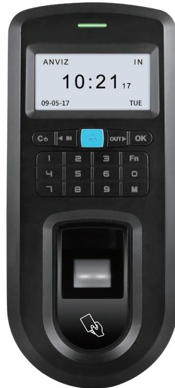
VF30指纹门禁机是针对中小型规模门禁系统应用而研发的一款专业级门禁设备，经典的外观设计，上市以来，畅销超过10年。VF30集成指纹验证，射频卡识别、门磁监控、防拆报警、门禁考勤记录等多种功能于一体，质量稳定可靠，支持多国语言，操作界面友好，强大的通讯功能适应于不同场合下数据管理；并标配功能齐全的后台管理软件，兼容多种数据库类型，支持门禁时段分组功能，在易用性、适用性和功能方面得到了完美均衡。该设备终端可广泛应用于办公室、写字楼、仓库、保密机关、档案室、计算机房、智能小区等门禁场合。
